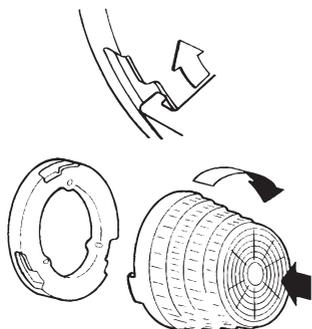
Pour l'installation sans conduit, des filtres à charbon sont nécessaires et doivent être installés avant la remise en place des filtres à graisse. Les filtres à charbon sont installés des deux côtés du ventilateur.
