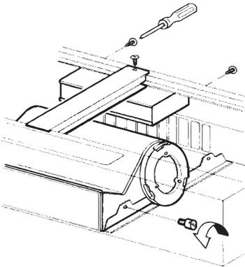
Retirer le support central et la boîte de contrôle en enlevant les vis tel qu'il est indiqué à la figure. Il n'est pas nécessaire de retirer le ventilateur.
