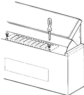
Fixer le couvercle derrière la grille d'évacuation à l'aide de deux vis argenté **12e** fournies avec la hotte.
