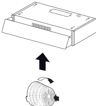
Fixez les filtres à charbon à la grille noire de chaque côté du ventilateur. Pressez fermement le filtre à charbon contre la grille noire de chaque côté du ventilateur et faites tourner le filtre dans le sens des aiguilles d'une montre (vers l'avant de la hotte) jusqu'à ce qu'il soit verrouillé en place. Faites tourner dans le sens contraire des aiguilles d'une montre (vers l'arrière de la hotte) pour l'enlever.
