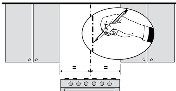
Tracez une ligne verticale sur le mur d'appui le plus haut que possible, au centre de l'emplacement où la hotte sera installée.
