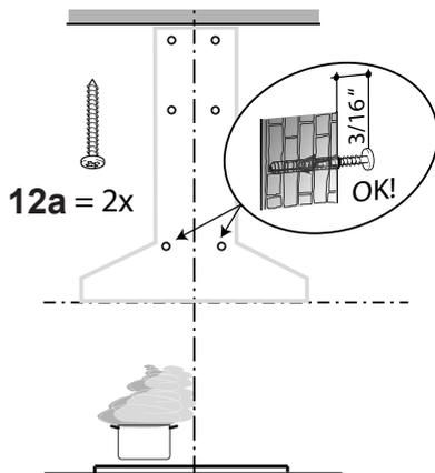
Insérez partiellement les deux vis 12a fournies dans les trous de fixation du bâti de la hotte, comme illustré.
