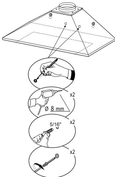
À l'intérieur du bâti de la hotte, marquez l'emplacement du trou de la vis d'ancrage, percez un trou de  $\varnothing 5/16"$  à l'endroit marqué, insérez 2 chevilles 11 dans les trous et fixez le bâti à l'aide de 2 vis.
