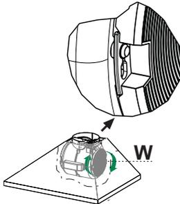
d'une montre (vers l'avant de la hotte) jusqu'à ce qu'il soit verrouillé en place. Faites tourner dans le sens contraire des aiguilles d'une montre (vers l'arrière de la hotte) pour l'enlever.
