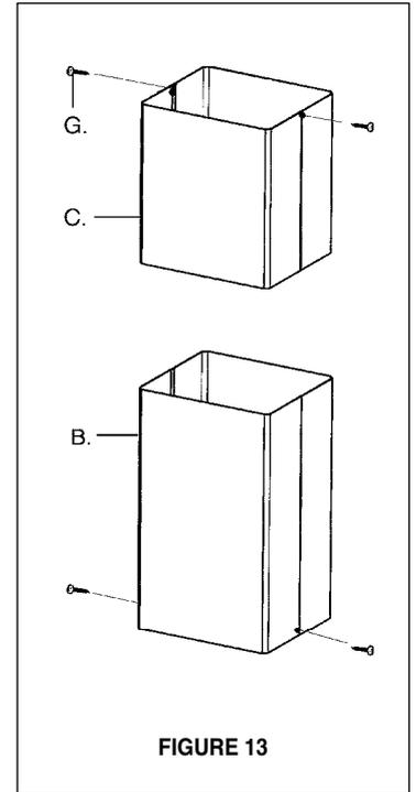
Pour installations sans conduit, aligner les DUCTLESS DIVERTER EXTENSIONS HORIZONTAL (**B de la FIGURE 12**) avec les trous d'échappement d'air dans COUVERCLE CHEMINÉE INFÉRIEURE (**D de la FIGURE 12**) et installer les VENT GRIDS (**C de la FIGURE 12**).
