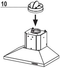
Instale el registro que se incluye con la campana antes de la conexión a la red de conductos.
