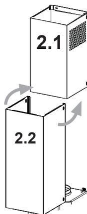
Agrande ligeramente los dos lados de la campana de la chimenea inferior y engánchelos entre la sección superior y la pared, asegurándose de que estén debidamente alojados.
