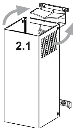
Écartez légèrement les deux côtés de la cheminée supérieure et engagez-les derrière les brides, et raccordez le déflecteur de recyclage, en vous assurant qu'ils sont solidement ancrés.
