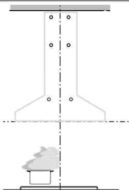
Les vis d'installation fournies doivent être renforcées par des chevilles (achetées séparément).
