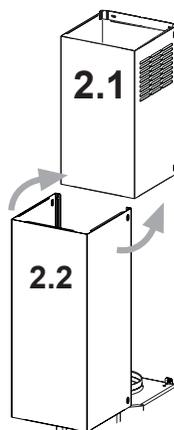
Écartez légèrement les deux côtés de la section inférieure de la cheminée de hotte et assemblez-les entre la section supérieure et le mur, en vous assurant qu'ils sont correctement installés.
