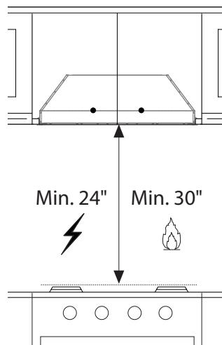
**MIN. 24" OVER ELECTRIC/MIN. 30" OVER GAS**
