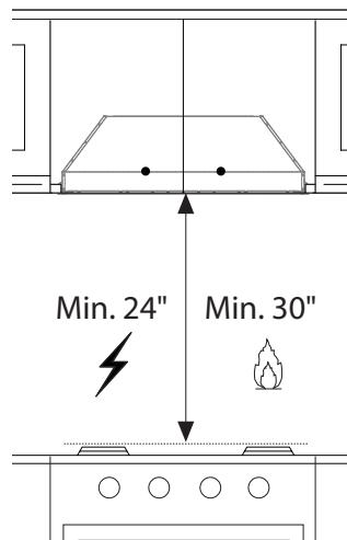
**MIN. 24" SUR ÉLECTRIQUE/MIN. 30" SUR GAZ**
