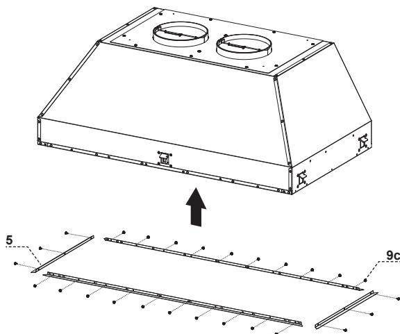
Siga los pasos 1 y 2 para conectar los conductos y pruebe la conexión eléctrica.
