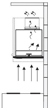
Pour la ventilation avec recirculation sans canalisation, dirigez les conduits à un emplacement au-dessus de la hotte où l'air évacué est retourné dans la pièce.
