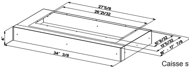
Caisse standard 36", acier inoxydable (LINE36ST), conçue pour les installations d'une largeur de 36".
