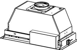
noire de chaque côté du ventilateur et faites tourner le filtre dans le sens des aiguilles d'une montre (vers l'avant de la hotte encastrable) jusqu'à ce qu'il soit verrouillé en place. Faites tourner dans le sens contraire des aiguilles d'une montre (vers l'arrière de la hotte encastrable) pour l'enlever.
