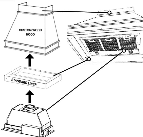
1. L'habillage de hotte sur mesure/en bois doit présenter une base solide (contre-plaqué de 3/4" recommandé) pour permettre l'ouverture pour la hotte Inca HC SS. La base doit être amincie pour accueillir la hauteur de la caisse (consultez **DIMENSIONS DE LA CAISSE** à la page 12). La caisse se fixe au bas de la base à l'aide de vis adaptées à la dimension et au matériau de votre habillage de hotte sur mesure/en bois. La hotte Inca HC SS s'insère dans l'ouverture de la caisse et de la base.
