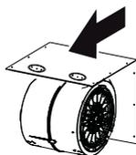
Lorsque le ventilateur est en place, posez les 12 vis pour fixer le moteur au bâti de la hotte encastrable.
