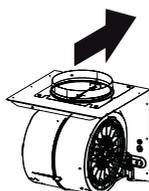
Pour l'installation d'une canalisation horizontale, le moteur doit d'abord être détaché. Pour ce faire, retirez les 12 vis comme illustré.
