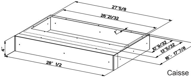
Caisse standard 30", acier inoxydable (LINE30ST), conçue pour les installations d'une largeur de 30".
