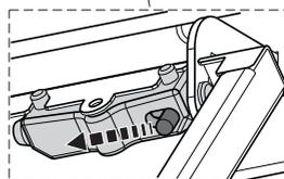
Vissez le bâti en place à l'aide des 6 vis **12f**, et rebranchez les câbles au connecteur et le câble de mise à la terre électrique (jaune/vert) retirés précédemment. Remettez en place le filtre à graisse métallique et le panneau.
