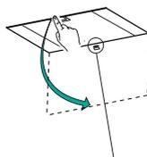
Retirez les filtres à graisse et mettez-les à part.
