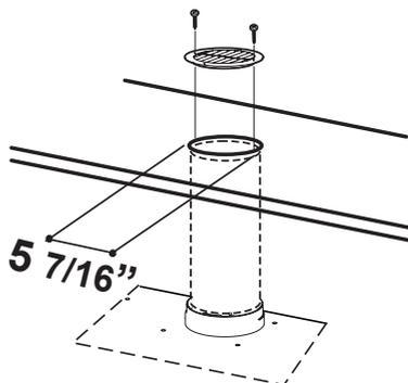
Pour la ventilation avec recirculation sans canalisation, dirigez les conduits à un emplacement au-dessus de la hotte où l'air évacué est retourné dans la pièce.
