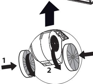
Fixez les filtres à charbon à la grille noire de chaque côté du ventilateur. Pressez fermement le filtre à charbon contre la grille noire de chaque côté du ventilateur et faites tourner le filtre dans le sens des aiguilles d'une montre (vers l'avant de la hotte encastrable) jusqu'à ce qu'il soit verrouillé en place. Faites tourner dans le sens contraire des aiguilles d'une montre (vers l'arrière de la hotte encastrable) pour l'enlever.
