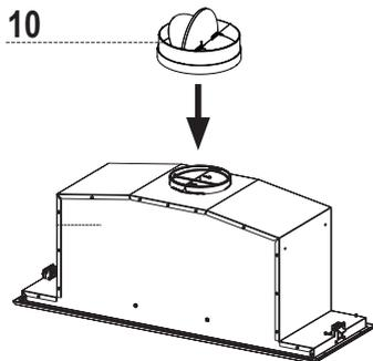
Installez le registre inclus avec la hotte avant de la raccorder aux conduits.
