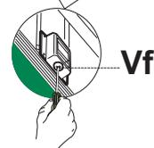
Insérez la hotte jusqu'à ce que les appuis latéraux s'enclenchent. Fixez-la à l'aide des 10 vis **12a** fournies. Verrouillez en serrant les vis **Vf** du dessous de la hotte.
