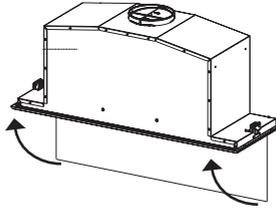
Fermez le panneau de protection du filtre en le poussant en place jusqu'à ce que le mécanisme de verrouillage se déclenche.
