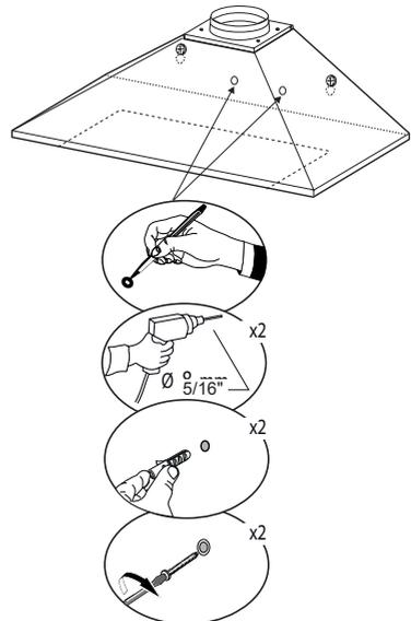
Desde el interior del cuerpo de la campana, marque el orificio de seguridad, taladre con  $\varnothing 5/16''$  donde está marcado, inserte 2 tacos en los agujeros y fíjelos con 2 tornillos 12a.
