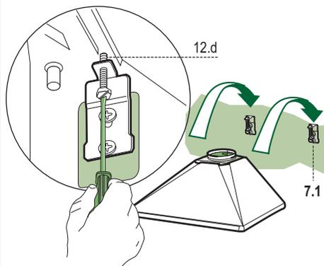
Posez les deux vis 12d sur les brides 7.1. Engagez le bâti de la hotte sur la bride 7.1, en le centrant autour de la ligne verticale. Utilisez les vis de réglage 12d sous la hotte pour mettre à niveau le bâti de la hotte.
