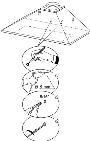
À l'intérieur du bâti de la hotte, marquez l'emplacement du trou de la vis d'ancrage, percez un trou de  $\varnothing$  5/16" à l'endroit marqué, insérez 2 chevilles dans les trous et fixez le bâti à l'aide de 2 vis 12a.
