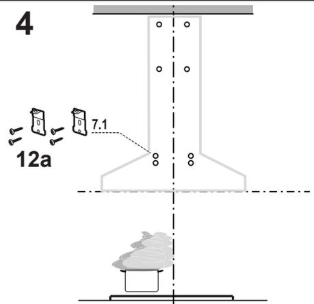
Fije los soportes 7.1 utilizando los tornillos 12a suministrados en los orificios de fijación del cuerpo de la campana, como se muestra.
