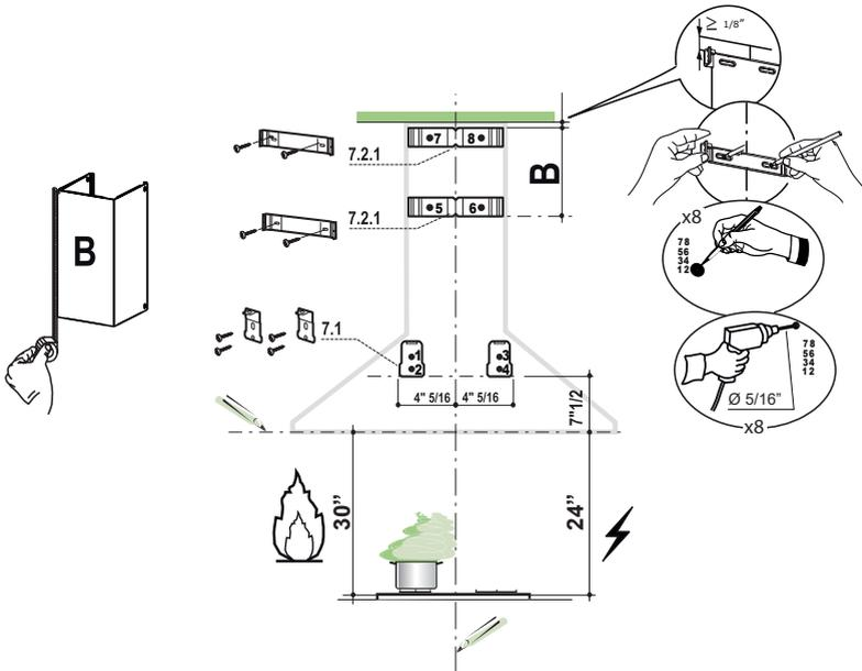
Coloque un soporte 7.2.1 en la pared como se muestra aproximadamente a 1/8" del techo o límite superior, alinee los centros (muesca) con la línea de referencia vertical y marque la pared en el centro del agujero en el soporte.
