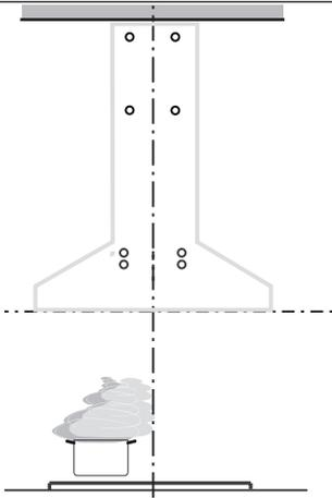
Los tornillos de instalación suministrados deben asegurarse con tacos de pared (se adquieren por separado).
