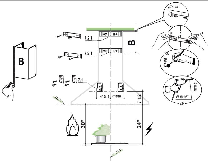
Placez la bride supérieure 7.2.1 sur le mur comme illustré, à environ 1/8" du plafond ou de la limite supérieure, en alignant les centres (encoche) avec la ligne de référence verticale. Marquez l'emplacement du centre des trous de la bride sur le mur.
