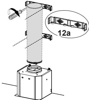
Installez les 2 brides de fixation 7.2.1 à l'aide des trous percés au milieu et au haut, et fixez-les à l'aide de vis 12a comme illustré.
