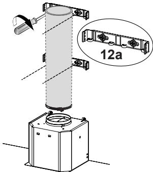
Instale los 2 soportes de fijación 7.2.1 en los orificios central y superior, y asegúrelos con los tornillos 12a como se muestra.
