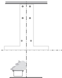
Los tornillos de instalación suministrados deben asegurarse con tacos de pared (se adquieren por separado).
