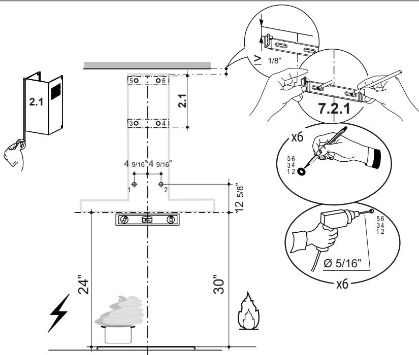
Tracez une ligne horizontale à la distance indiquée au-dessus de la surface de cuisson.
