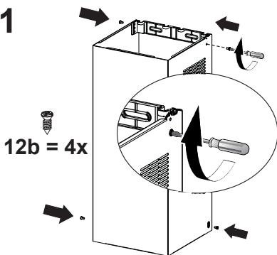
Asegure los lados a los soportes con los 4 tornillos 12b.
