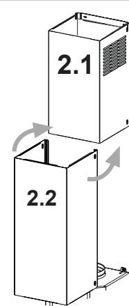
Agrande ligeramente los dos lados de la campana de la chimenea inferior y engáñchelos entre la sección superior y la pared, asegurándose de que estén debidamente alojados.
