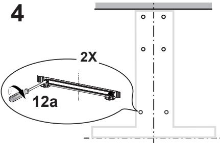
Inserte los dos tornillos 12a suministrados con la campana en el soporte de fijación como se muestra y no los apriete completamente hasta la pared, dejando expuestos 3/16" de las cabezas de los tornillos.
