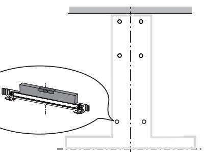
Use un nivel para asegurar que el soporte de fijación esté nivelado y luego asegure completamente los dos tornillos.
