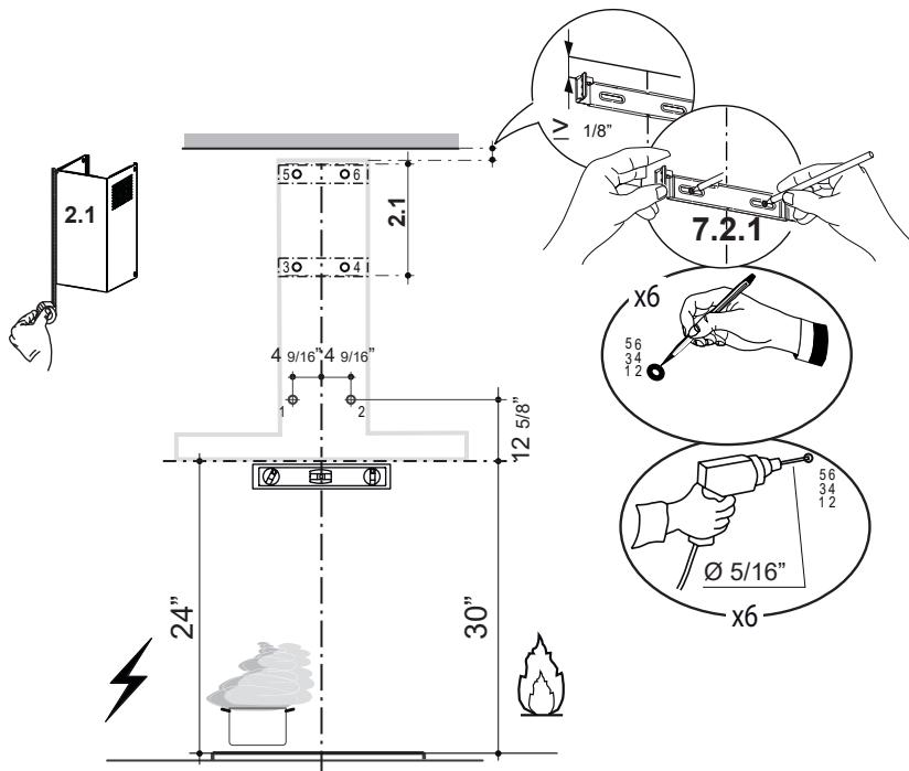
Dibuje una línea horizontal donde se indica arriba de la superficie de cocción.
