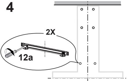
Inserte los dos tornillos 12a suministrados con la campana en el soporte de fijación como se muestra y no los apriete completamente hasta la pared, dejando expuestos  $\frac{3}{16}$ " de las cabezas de los tornillos.
