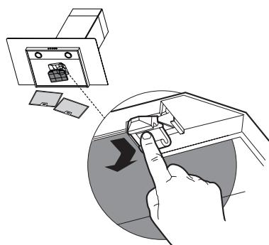
**PRECAUCIÓN:** Cuando se utiliza en el modo de recirculación, para reducir el riesgo de incendio y descarga eléctrica, utilice sólo el kit de conversión Modelo FILTER2.
