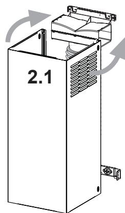
Ligeramente ensanche los dos lados de la chimenea superior y engáncelos detrás de los soportes y conéctelos al desviador sin conducto, asegurándose de que estén bien asentados.
