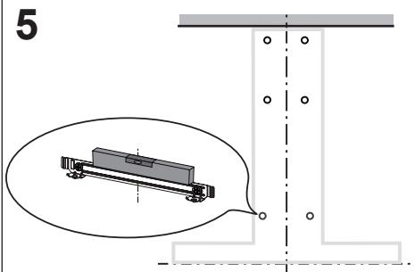
Use un nivel para asegurar que el soporte de fijación esté nivelado y luego asegure completamente los dos tornillos.
