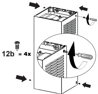
Asegure los lados a los soportes con los 4 tornillos 12b.
