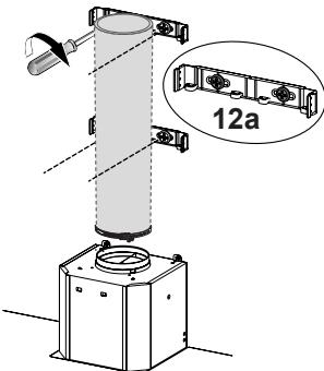
Instale los 2 soportes de fijación 7.2.1 en los orificios central y superior, y asegúrelos con los tornillos 12a como se muestra.
