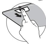
Retirez les filtres un à un, en les poussant simultanément vers l'arrière du groupe et en les tirant vers le bas.
