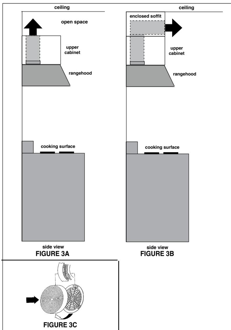
**REMARQUE:** il est recommandé que la cuisine de style professionnel toujours être ventilé à l'extérieur; pour recycler installations, des travaux de conduit est nécessaire pour épuiser l'unité hors de l'armoire. Pour le modèle 48", pour deux kits, un pour chaque moteur.
