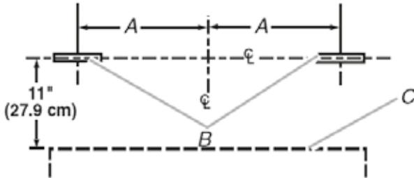
A : Distance de centre de support à la ligne centrale : 30" ; capot : 13 15/32" ; /36" ; capot : 16 15/32" ; /42" ; capot : 19 15/32" ; /48" ; capot : 22 15/32" ; B : Supports C : Dessus de capot
