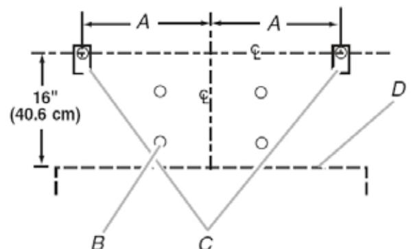
A : Distance de centre de support à la ligne centrale : 30" ; capot : 13 3/8" ; /36" ; capot : 16 3/8" ; /42" ; capot : 19 7/16" ; /48" ; capot : 22 3/8" ;
