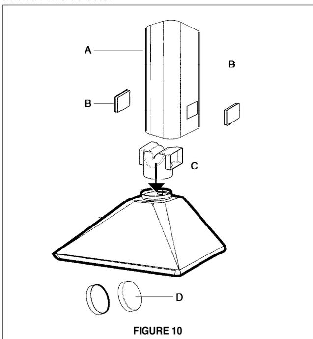
Une fois le couvercle de CHEMINÉE INFÉRIEURE AVEC TROUS installé, les GRILLES sont insérées dans les trous, tel qu'il est illustré à la B de la **FIGURE 11**.
